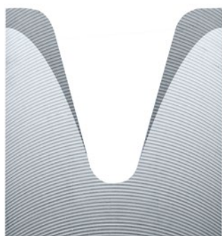
Herramienta inferior con el proceso aplicado de templado profundo por CNC.
