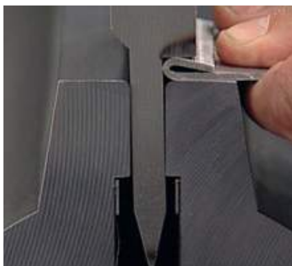
Vorbiegen und Zudrücken in einem Werkzeug.
